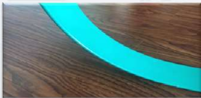
彎曲處無龜裂
